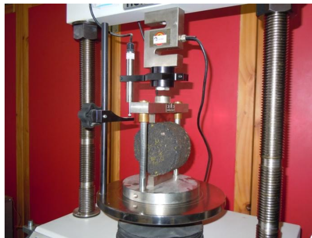
Figura 9. Ensayo de tensión indirecta, ITS.
