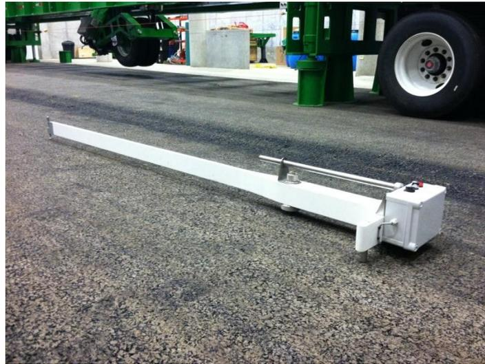
Figura 44. Deflectómetro de superficie del pavimento.
