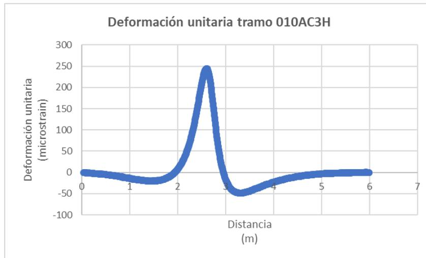
Figura 71. Pulso generado durante la captura de deformaciones unitarias en el tramo 010AC3H.
