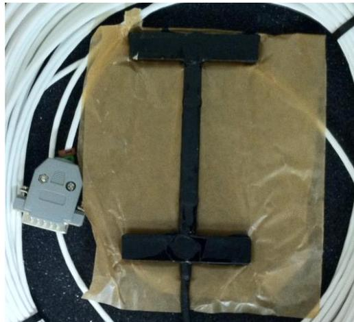
Figura 36. Transductor para medición de deformaciones unitarias.
