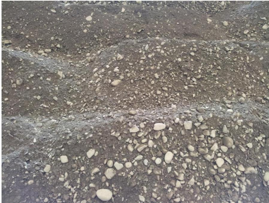
Figura 4. Material de sub-base utilizado en la estructura de pavimento.
