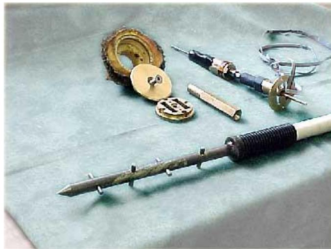
Figura 38. Elementos que componen el montaje del Deflectómetro de Profundidad Múltiple.
