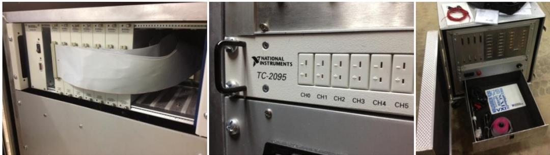
Figura 47. Sistema de Adquisición de Datos (DAS).
