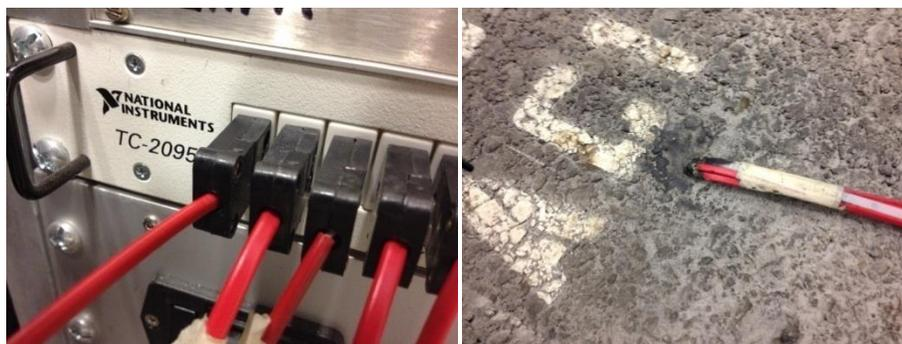
Figura 45. Termocuplas instaladas en los tramos
