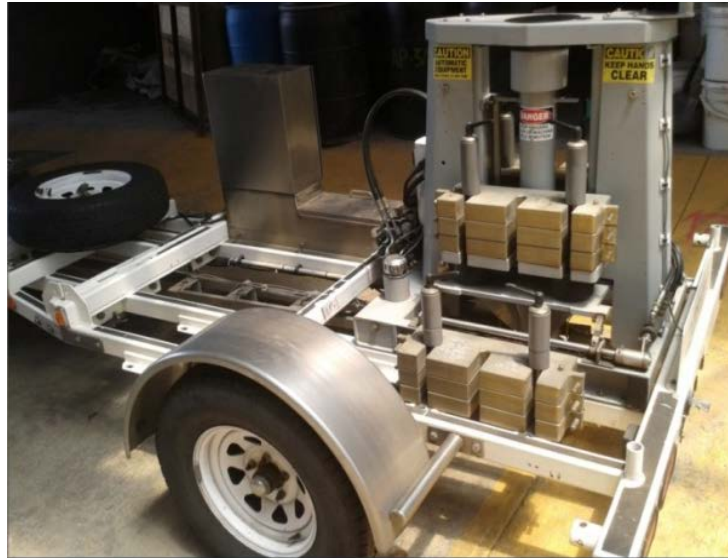
Figura 2. Deflectómetro de impacto (FWD) LanammeUCR Fuente: LanammeUCR, 2008
