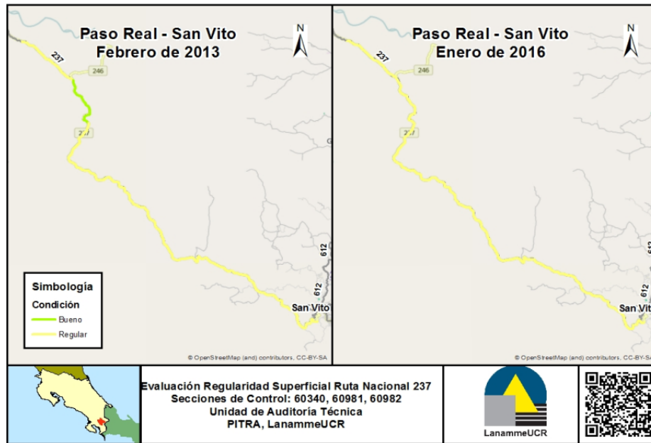
Figura 9. Comparación del estado de Regularidad Superficial del tramo Paso Real – San Vito entre los años 2013 y 2016
