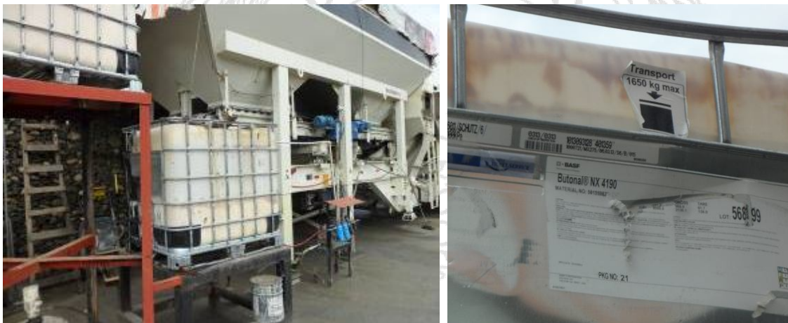
Figura 3. Contenedor del polímero utilizado en la producción de mezcla asfáltica. Se muestra la identificación del aditivo.
