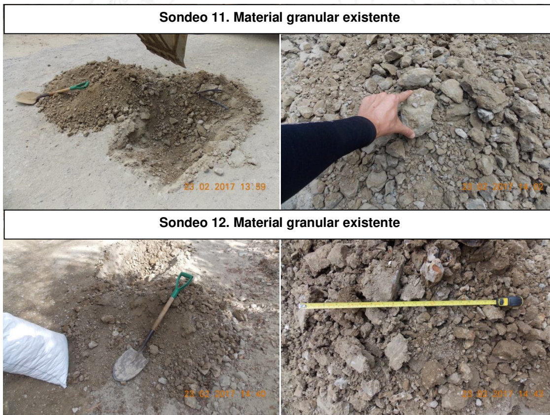
Figura 10. Sondeos y muestreo de material de capa granular existente en Camino Santa Teresa.
