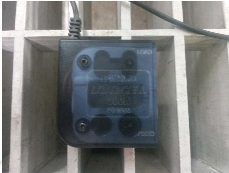
**Figura 6.** Celda de carga de PASCO
