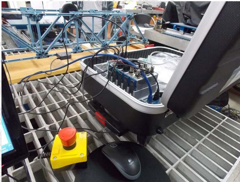
**Figura 8.** Sistema de adquisición de datos CompactDAQ
