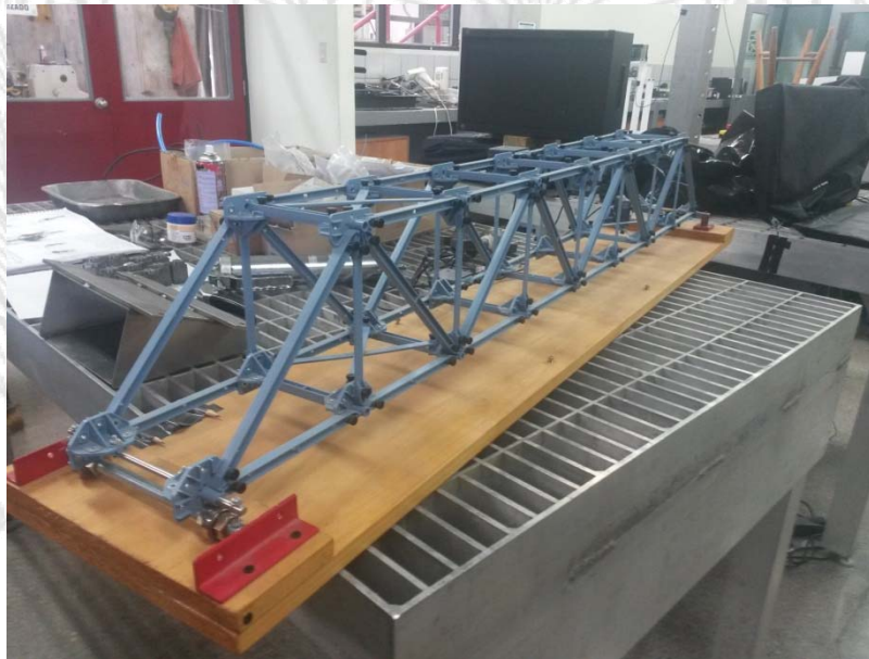
Figura 1. Modelo de puente tipo cercha de PASCO
