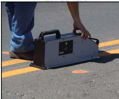
Fotografía 9. Medición de retrorreflexión con el equipo EASYLUX en el tramo de prueba, frente a la entrada principal del LanammeUCR.
