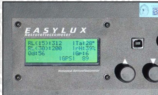
Fotografía 10. Pantalla del equipo EASYLUX, donde se indican los valores de retrorreflexión horizontal para las geometrías de 15 m y 30 m, así como el Q_d , la temperatura ambiente y el porcentaje de humedad relativa.
