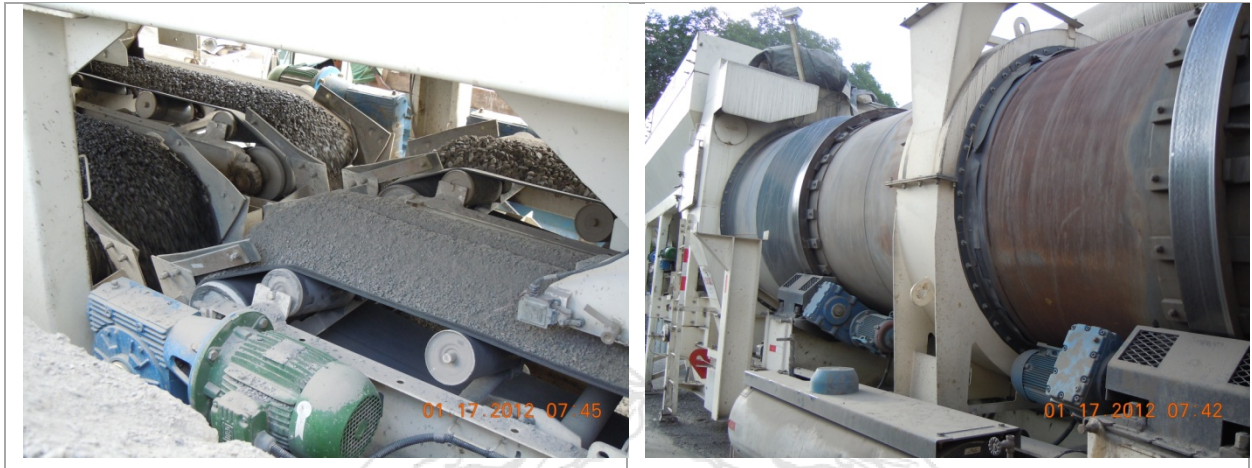
Fotografía 3 Fajas de transporte de agregados y tambor secador.
