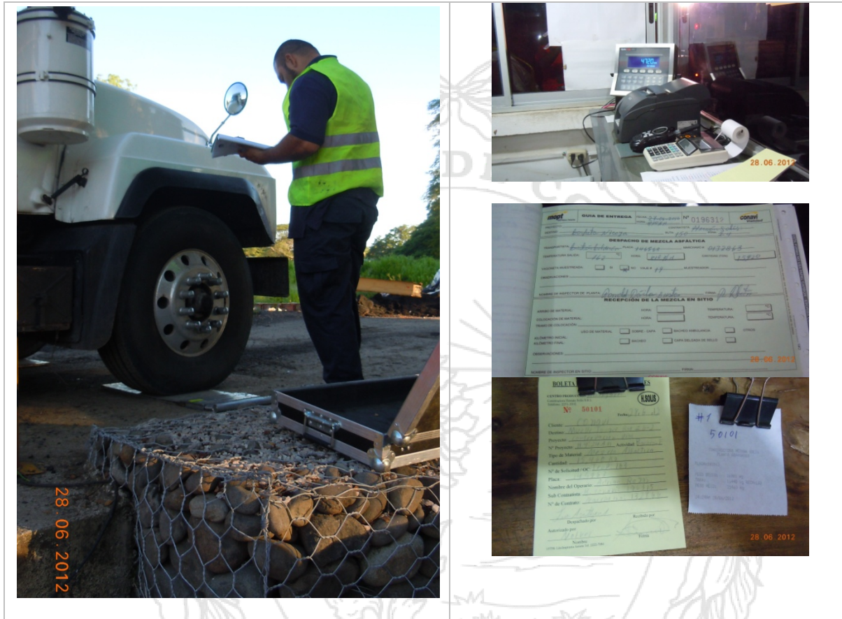
Fotografía 10. Pesaje de vagonetas en planta, pesaje en cabina de control, marchamo y boleta de despacho.
