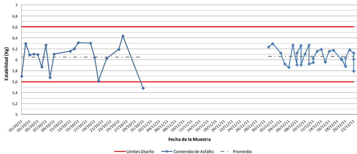
Gráfico B-9. Gráfico contenido de asfalto (PTM) de octubre a diciembre de 2011.
