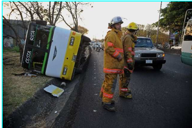
Fotografía 8: Vuelco de un autobús debido a cuneta profunda y ausencia de espaldón en Ruta Nacional No.1, Autopista General Cañas, Zona 1-1. Fuente: Sección Sucesos de Diario LA NACIÓN, 20 de marzo de 2012.
