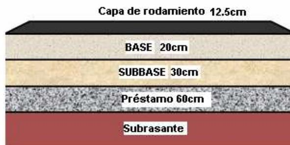
**Figura No.2:** Estructura típica de un pavimento.
