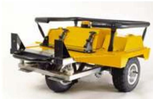
El Índice de Fricción fue presentado en 1995 por la PIARC (Asociación Mundial de la Carretera), como recomendación para la medida de la resistencia al deslizamiento. La medición de este parámetro permite comparar distintas condiciones de pavimento, desde el punto de vista de la seguridad ante el deslizamiento de los vehículos en condiciones de lluvia por bajos valores del coeficiente de fricción.
