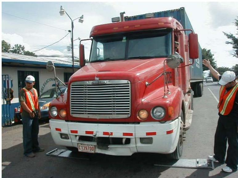
**Figura 11:** Pesaje efectuado por el Lanamme-UCR
