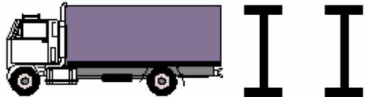
**Figura 4:** Camión con eje simple trasero (C2+)
