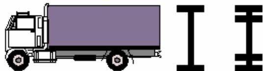
**Figura 5:** Camión con eje dual trasero (C2)
