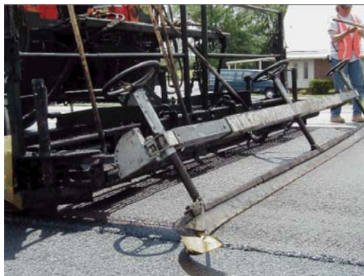
b. Enrasador flexible auxiliar Figura tomada de Presentación de Scott Metcalf en Conferencia PPTG 2007
