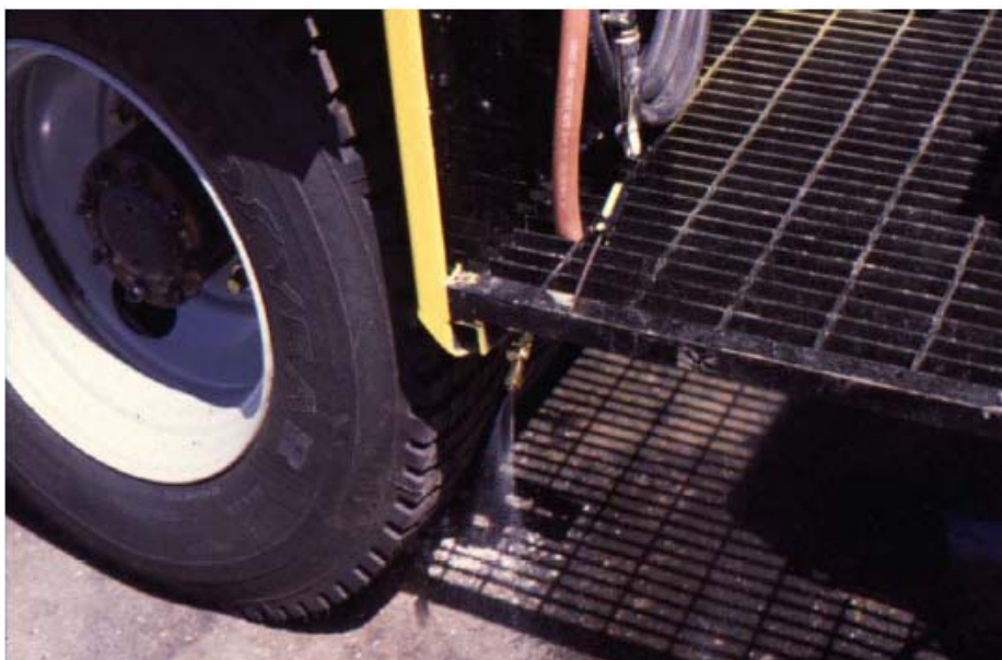
Figura 29: Dispositivo para humedecer la superficie en el camión mezclador.
