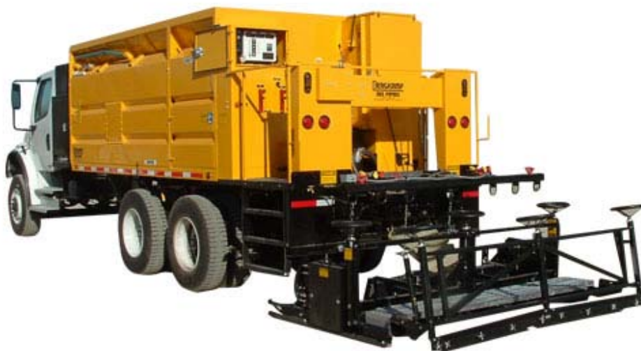
Figura 28: Equipo para la fabricación y colocación de sellos de lechada asfáltica.
