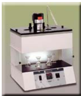
Figura 19: Equipo de ensayo para viscosidad Saybolt Furol.
