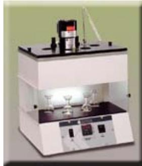
**Figura 4:** Equipo de ensayo para viscosidad Saybolt Furol.
