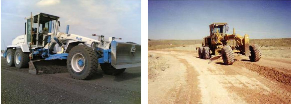
**Figura 17:** Equipo moto niveladora para mezclado con cuchilla.
