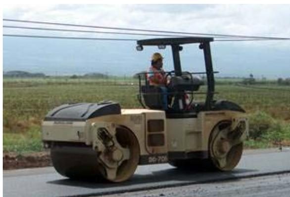
**Figura 23:** Compactadores de rodillo metálico.
