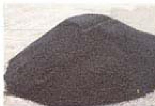
**Figura 1:** Mezcla en frío tipo apilamiento de uso inmediato.
