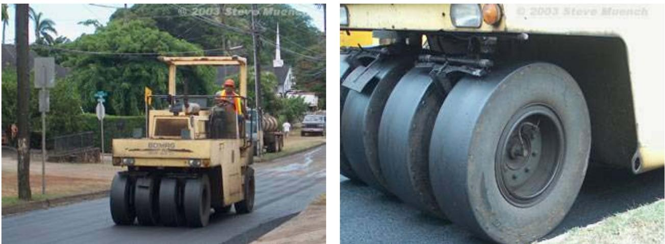
**Figura 22:** Compactadores de llanta de hule.
