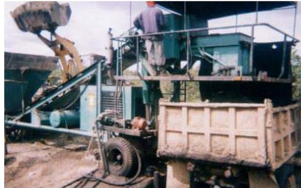
b. Planta de producción de la mezcla en frío
