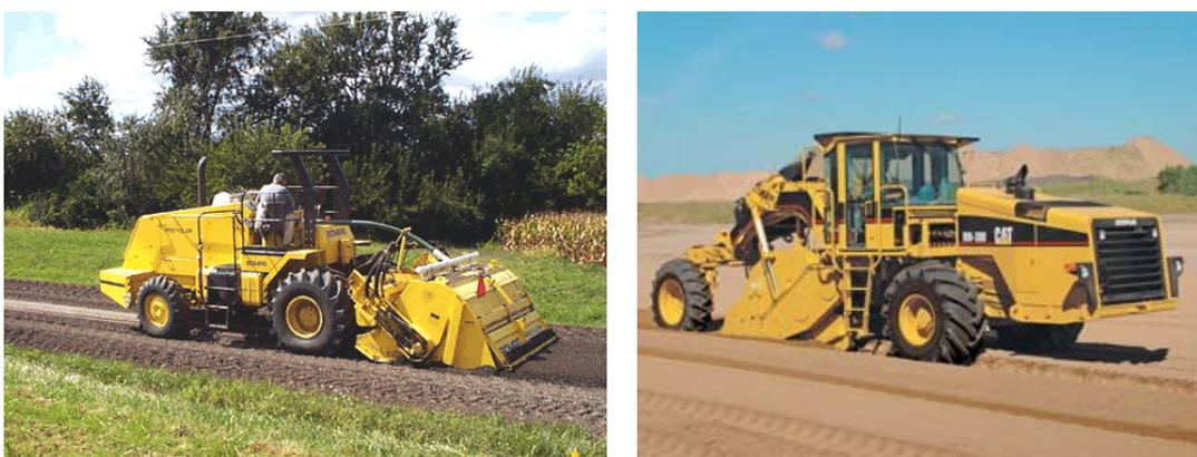
**Figura 14:** Mezcladoras rotatorias.
