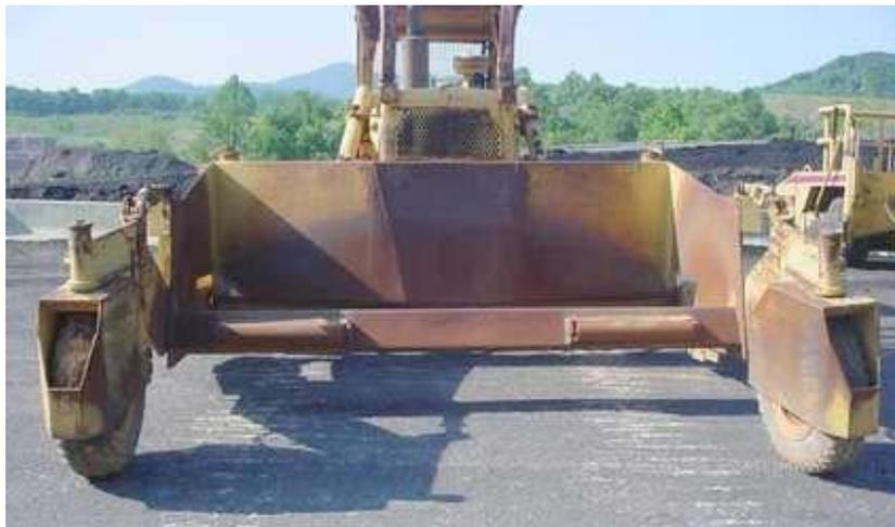
**Figura 35:** Equipo para extendido de la mezcla.
