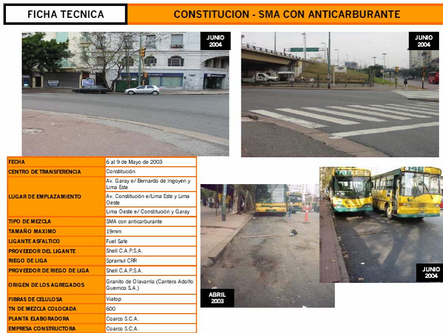
Figura 4 Características generales del proyecto e imágenes al inicio y un año después para el caso de la mezcla SMA con anticarbicante.
