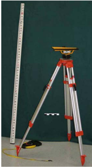
Figura 3: Nivel y mira topográfica
