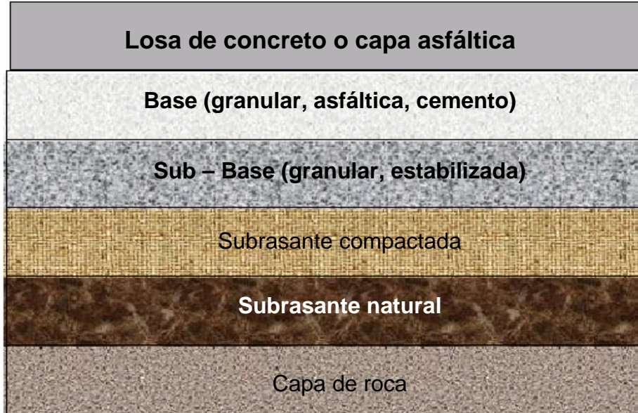
Figura C1: Capas que componen un pavimento
