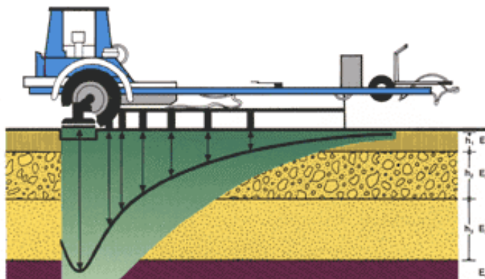
Figura B1: Respuesta de la estructura del pavimento a la carga suministrada por el deflectómetro de impacto
