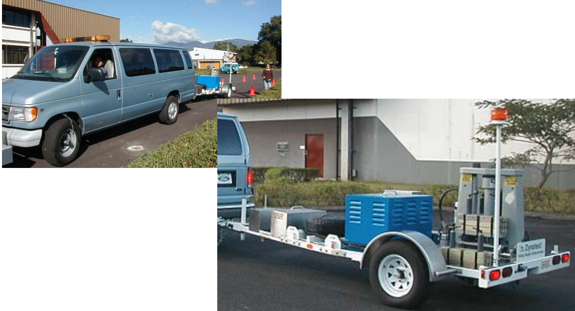
Fotografía B1: Deflectómetro de impacto
