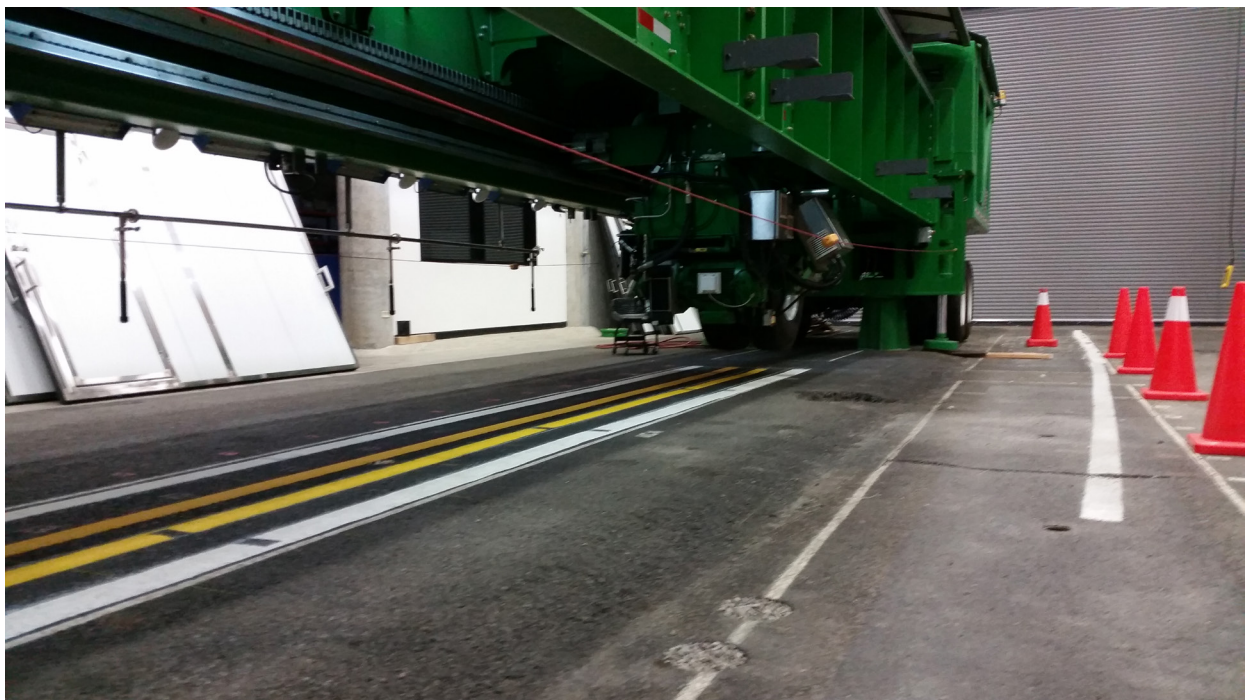
Figura 2. Demarcación de 4 líneas para ensayo de carga dinámica en el HVS
