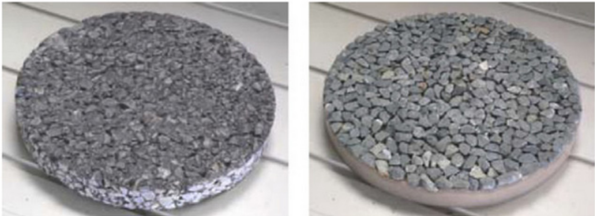
Figura 3. Pastillas de mezcla asfáltica y agregado evaluadas mediante la máquina Wehner-Schulze. Fuente: Modificado a partir de Minh-Tan Do et al, 2007.
