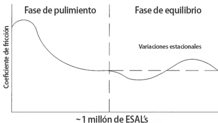
Figura 5. Modelo generalizado del pulido del pavimento. Fuente: Modificado a partir de Kokkalis, 1998
