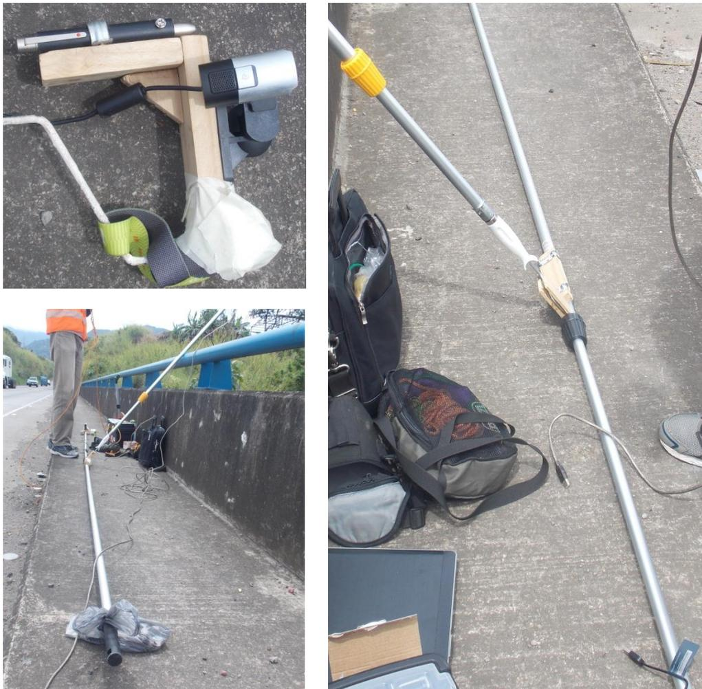
Figura 15. El ensamblaje del “T” invertido empleado para inspeccionar visualmente la superficie de la viga cajón
