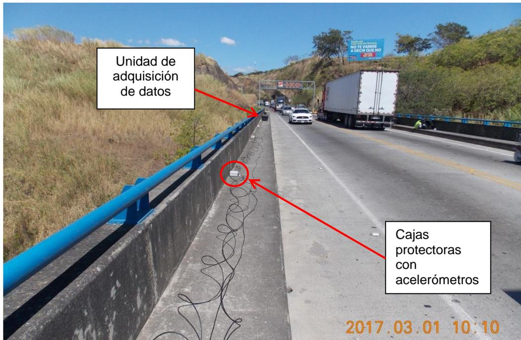
**Figura 5.** Colocación de sensores sobre las aceras del puente. Nótese que el monitoreo no interrumpe el tránsito de vehículos
