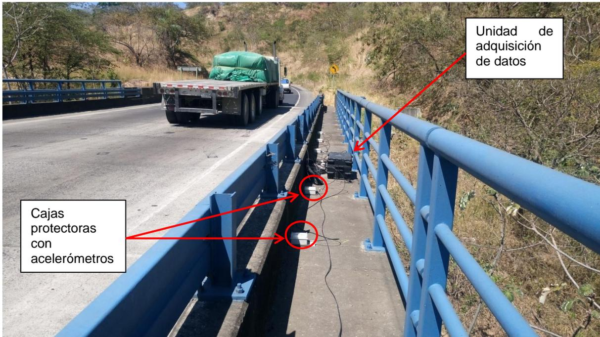
**Figura 5.** Colocación de sensores sobre las aceras del puente. Nótese que el monitoreo no interrumpe el tránsito de vehículos
