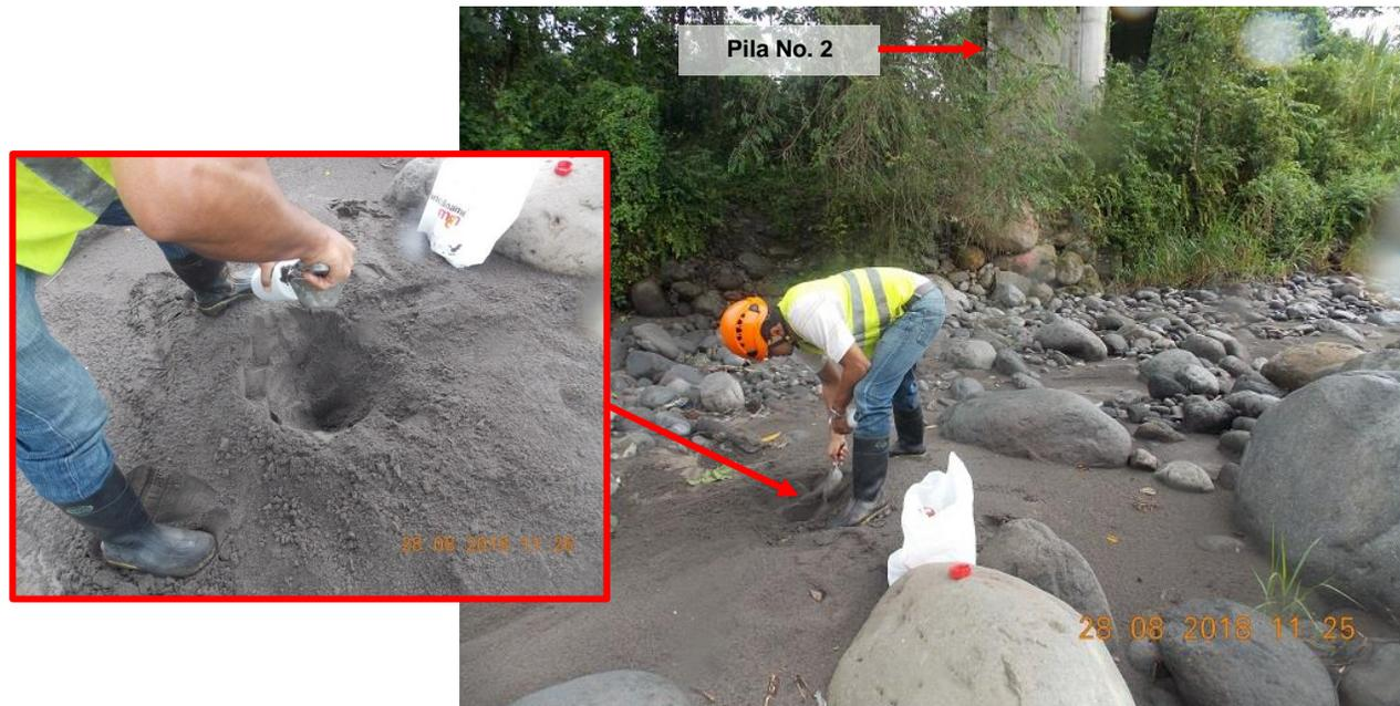
**Figura A.4.** Extracción de la muestra de suelo en el río (Suelo río).
