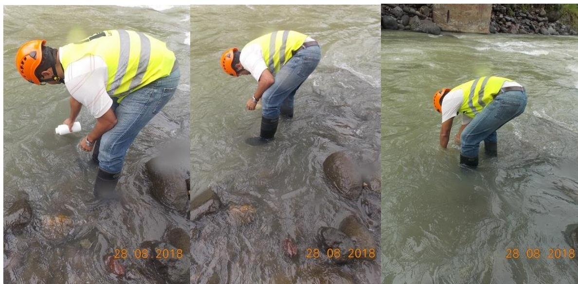
**Figura A.5.** Extracción de las muestras de agua en el río (Agua 1 (sup), Agua 2 (med) y Agua 3 (prof) respectivamente de izquierda a derecha).
