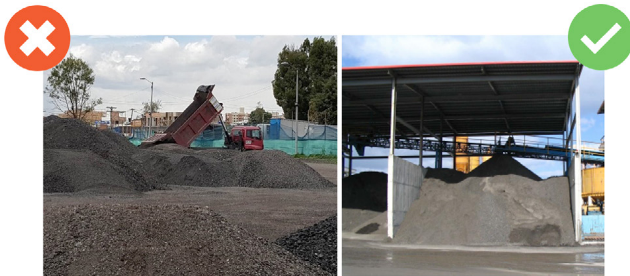
Figura 2. Almacenamiento del RAP
