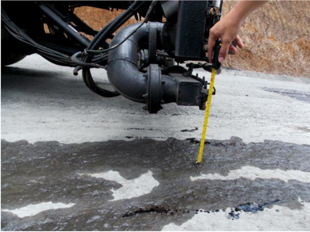
**Figura 13. Medición de la altura de la barra rociadora con cinta métrica**
