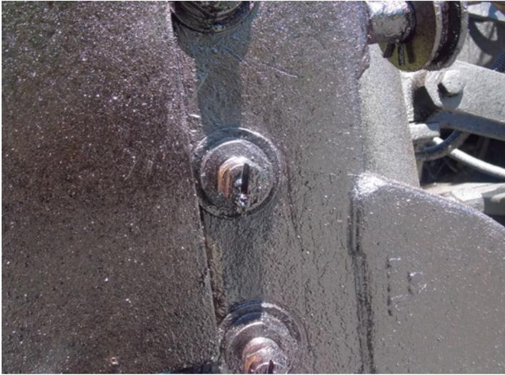
Figura 42. Ausencia de limpieza y obstrucción de boquillas
