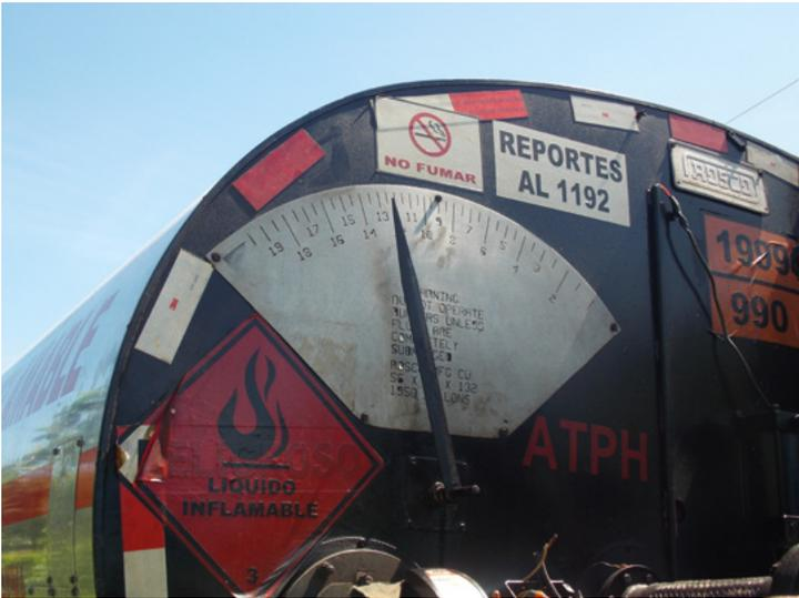
**Figura 22. Medidor volumétrico del tanque distribuidor**
