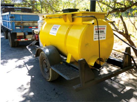
**Figura 9. Distribuidor manual de emulsión asfáltica**
