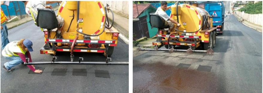
**Figura 17. Ensayos para verificar uniformidad de riego y determinar la cantidad de emulsión aplicada**
