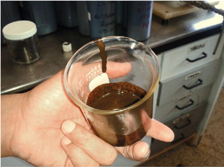
**Figura 10. Muestra de emulsión asfáltica**
