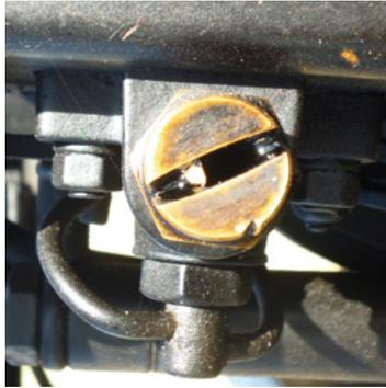
**Figura 7. Boquilla de barra rociadora**
