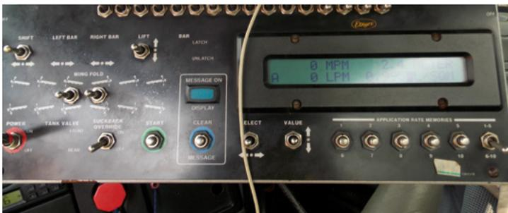
**Figura 8. Tablero de control a bordo del camión dosificador**
