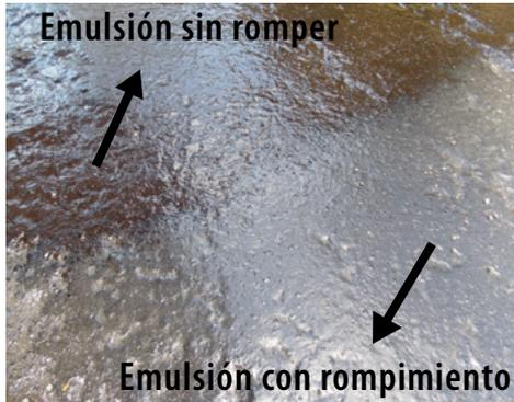
**Figura 1. Rompimiento de emulsión asfáltica**
