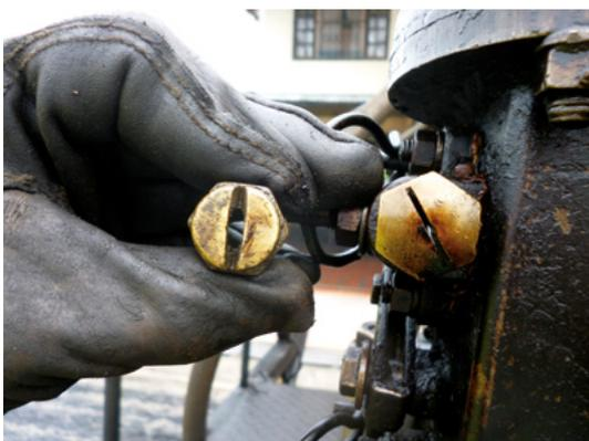
Figura 29. Selección de boquillas de acuerdo con las características del camión dosificador y la tasa de dosificación deseada
