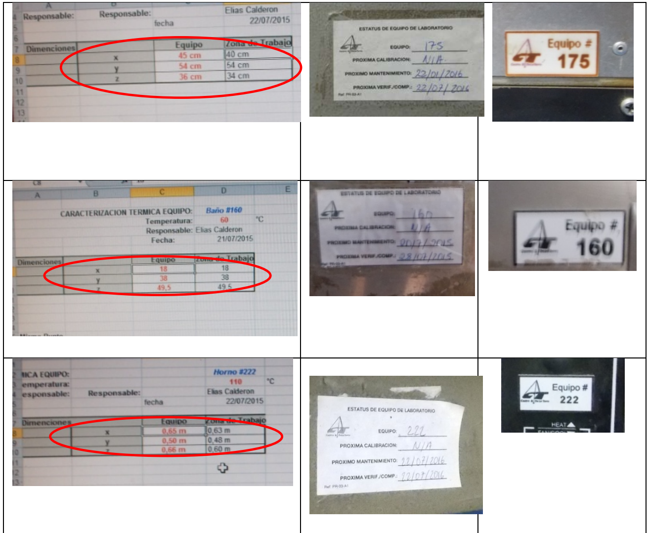
Fotografía 8. Registros de caracterizaciones térmicas de los hornos y baños del laboratorio así como las etiquetas de mantenimiento e identificación de los equipos. Ubicación: Laboratorio de Castro y de la Torre en Planta de Producción de Abangares, Fecha 11 de agosto de 2015. Fuente: LanammeUCR.
