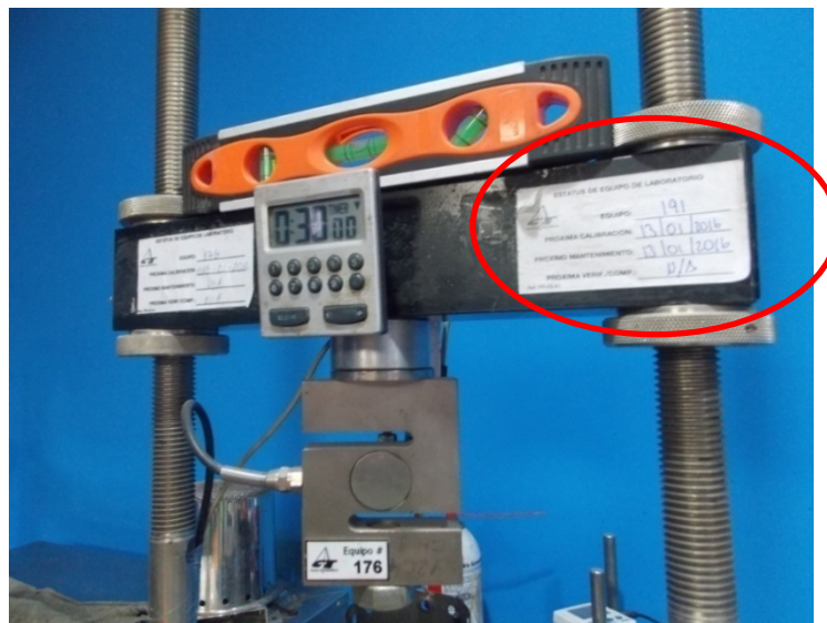
Fotografía 6. Etiqueta en el marco de carga del estabilómetro Marshall. Ubicación: Laboratorio de Castro y de la Torre en Planta de Producción de Abangares, Fecha 11 de agosto de 2015. Fuente: LanammeUCR.
