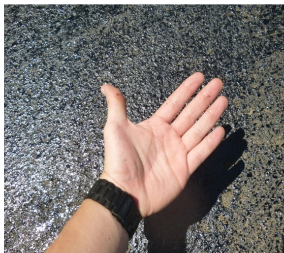
Fotografía 34. Arrastre de emulsión asfáltica una hora después de haberse colocado.
