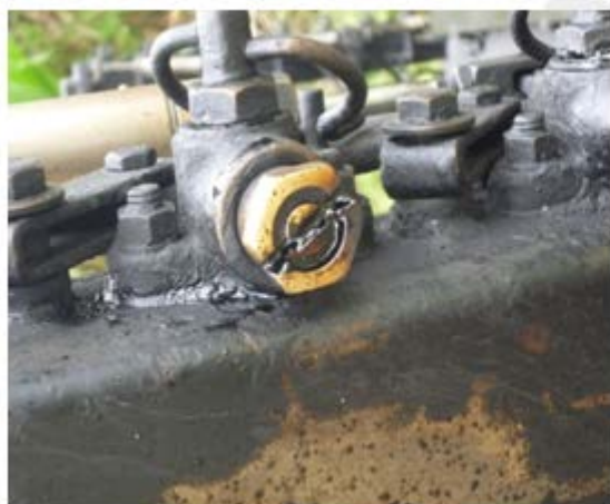
Fotografía 26. Boquilla adecuada de acuerdo a dosificación y presión aplicada. El operario del camión distribuidor contaba con los 2 juegos de boquillas. Se puede notar la diferencia en la abertura.
