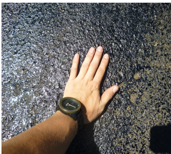
Fotografía 34. Arrastre de emulsión asfáltica una hora después de haberse colocado.
