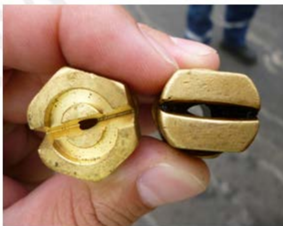
Fotografía 26. Boquilla adecuada de acuerdo a dosificación y presión aplicada. El operario del camión distribuidor contaba con los 2 juegos de boquillas. Se puede notar la diferencia en la abertura.
