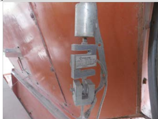
Fotografía 4. Celdas de pesaje
