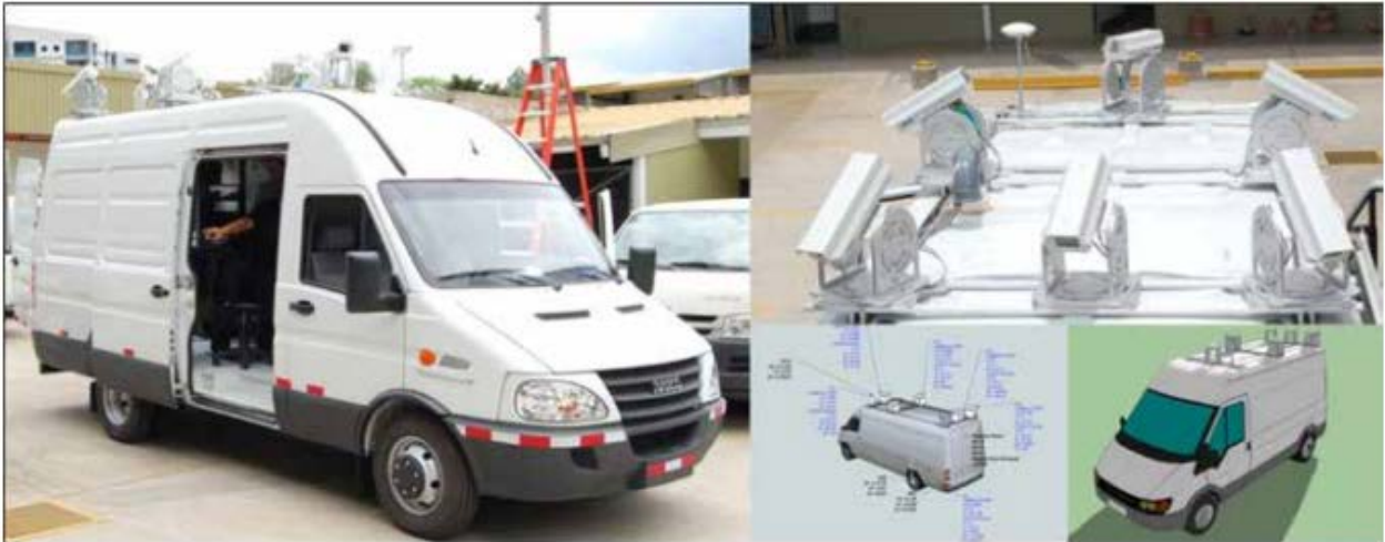
Figura 1. Equipo de imágenes digitales georeferenciadas. Fuente: Informe de Evaluación de Red Vial Nacional
