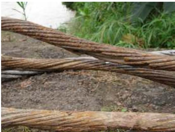
**Fotografía 3:** Varios hilos corroídos y fallados de un torón en una sección del cable alejada del punto de ruptura. Fecha 24 de octubre 2009.
