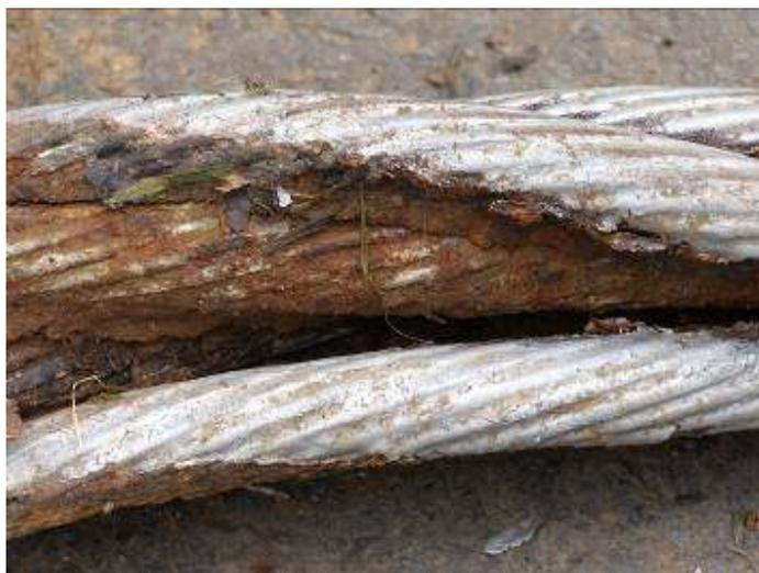
**Fotografía 2:** Oxidación en el interior del cable. Fecha 24 de octubre 2009
