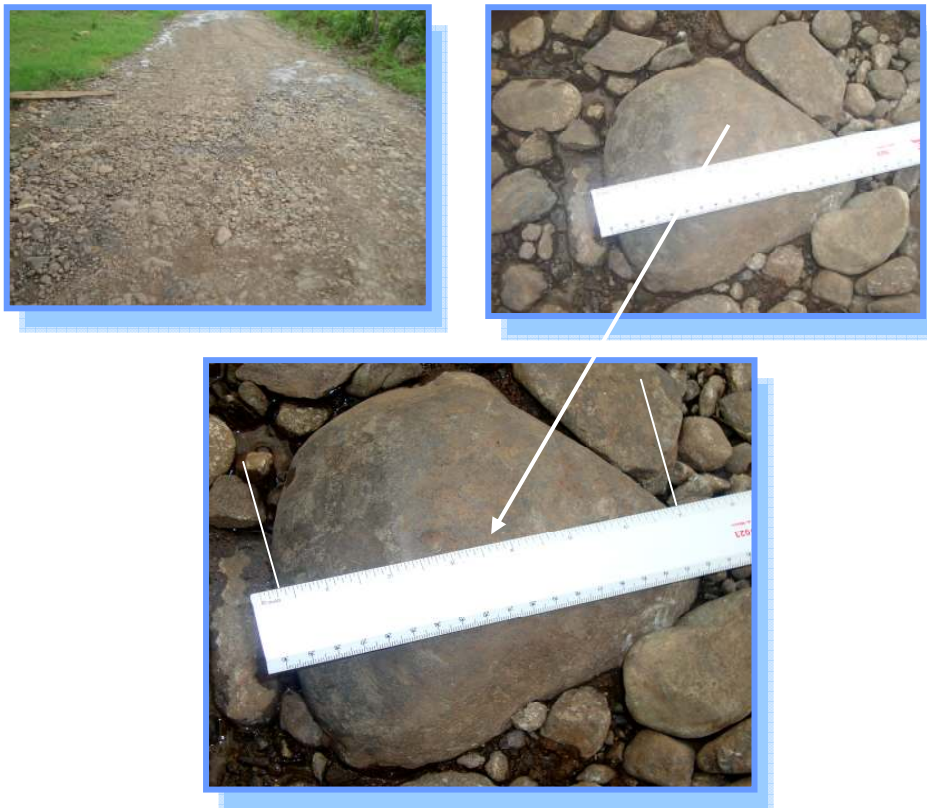
Fotografías N° 4: Estación 0+300, Acceso oficial por Villa Bruselas. Material con sobre-tamaño granulométrico, diámetro de 6.75". (Fecha de fotografías 08-Junio-2010)
