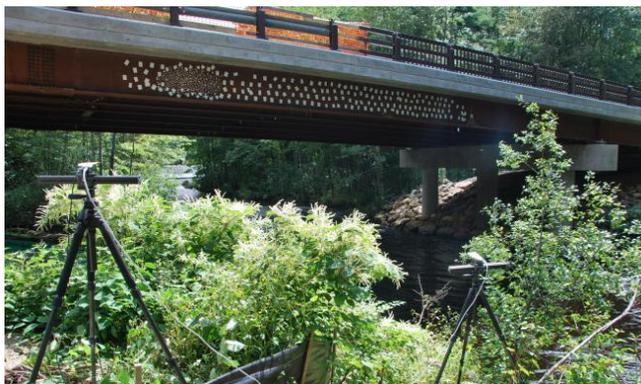
**Figura 21.** Instalación de las manchas aleatorias para el método CID.
