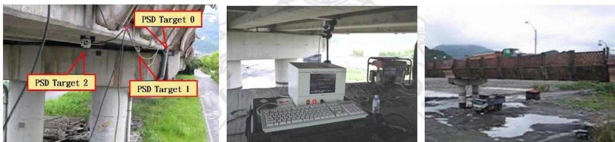
**Figura 19.** Instalación de los blancos y la cámara del sistema PSD y la prueba de carga.
