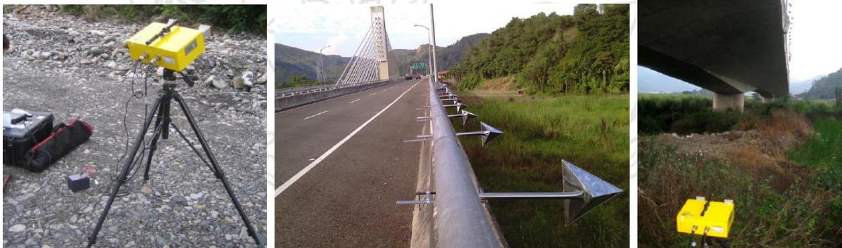
**Figura 15.** Instalación del equipo IBIS-S durante la medición del Puente Ai-Lan, Taiwán.
