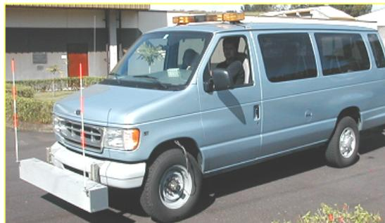
**Figura 21.** Perfilómetro Inercial Láser.
