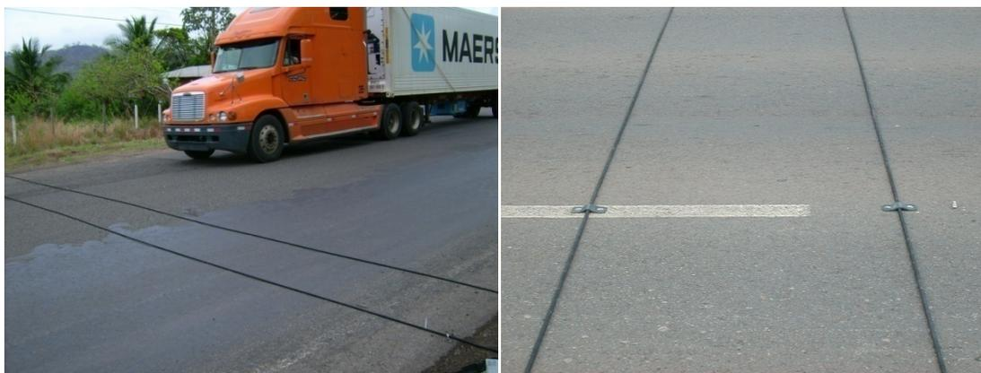
**Figura 6.** Cables y contadores automáticos en sitio.
