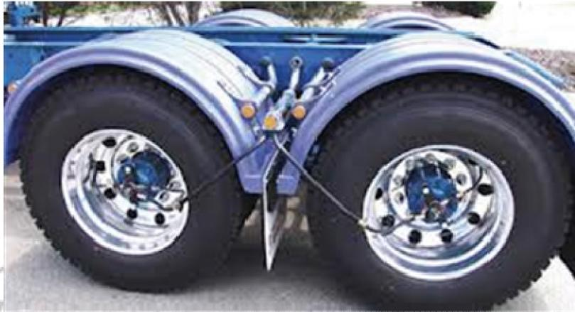
**Figura 10. Ejemplo de Sistema de Presión de Inflado Central**
