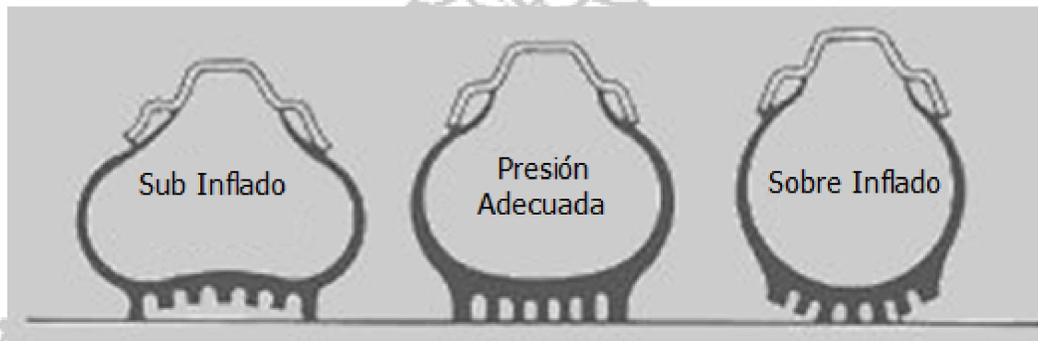
**Figura 5. Zona de Contacto del Neumático Dependiendo de su Presión.**
