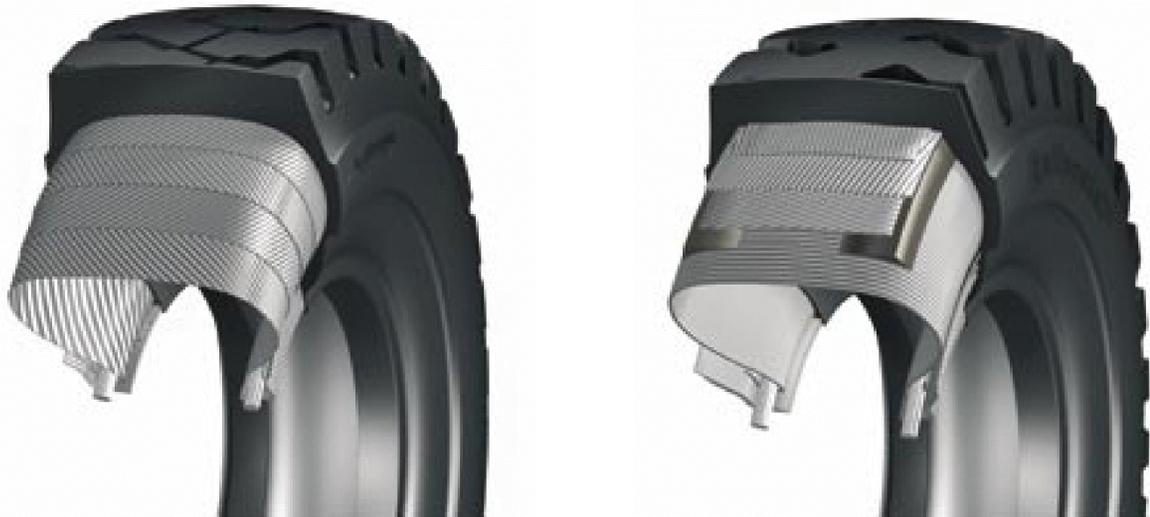
Figura 3. Neumático diagonal (izquierda) y Radial (derecha)
