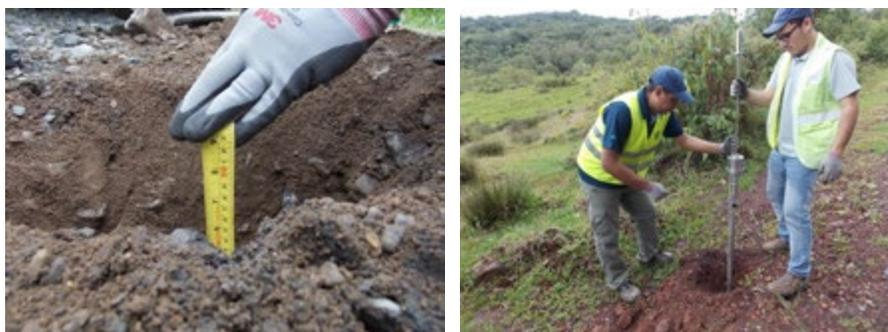
Figura 6: Rugosímetro III, utilizado para la evaluación de regularidad en vías en lastre.
