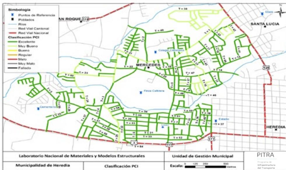
Figura 5: Valoración de condición de pavimento por medio del PCI.
