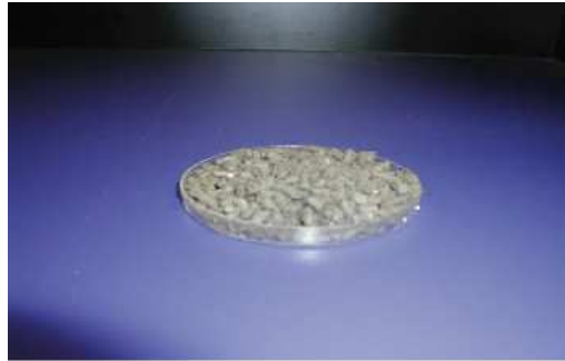
Figura No. 2: Fibra de celulosa en presentación granular
