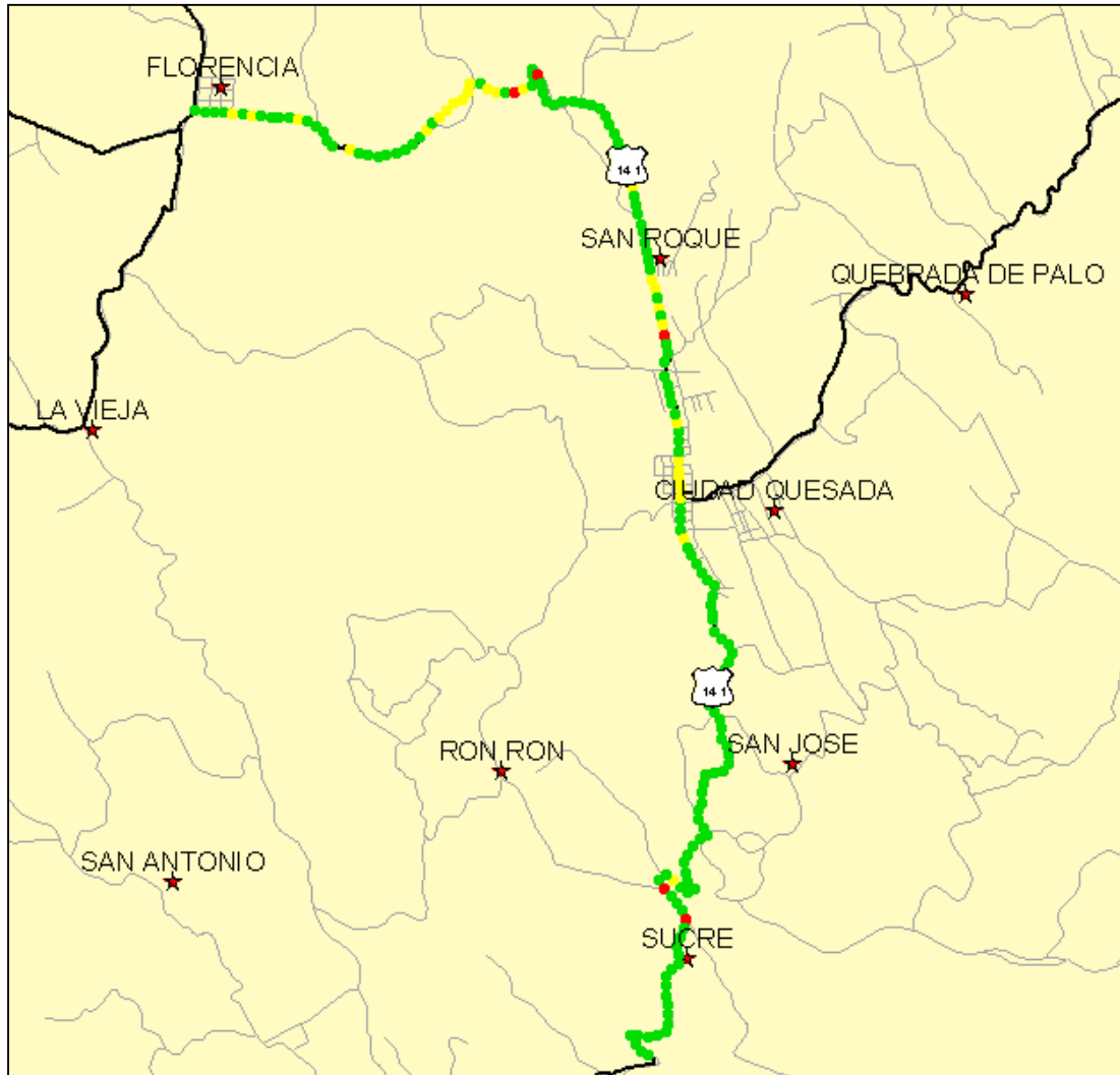
Figura 5. Ahuellamiento máximo medido en distintas ubicaciones del tramo de la Ruta 141.
