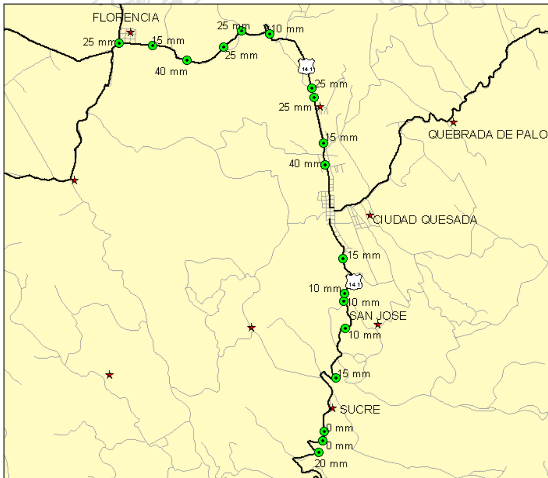
Figura 2. Ahuellamiento máximo medido en distintas ubicaciones del tramo de la Ruta 141.
