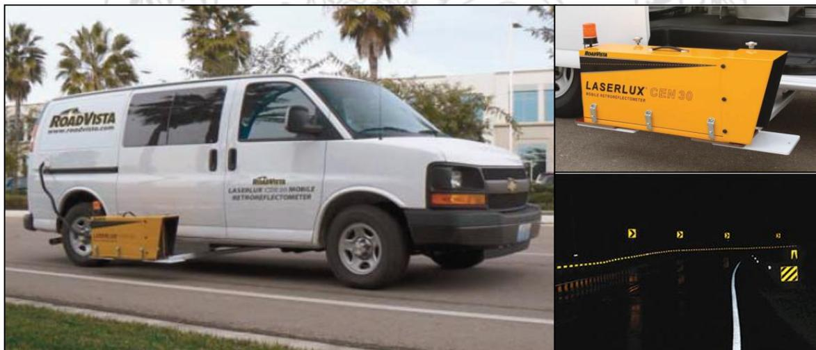
Figura 4-7 Equipo Laser para medición de retroreflectividad (LaserLUX CEN 30)
