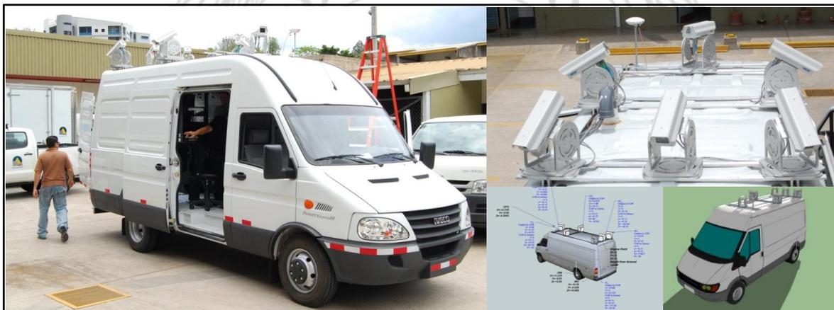
Figura 4-9 Vehículo del LanammeUCR equipado con el equipo Trimble GEO 3D
