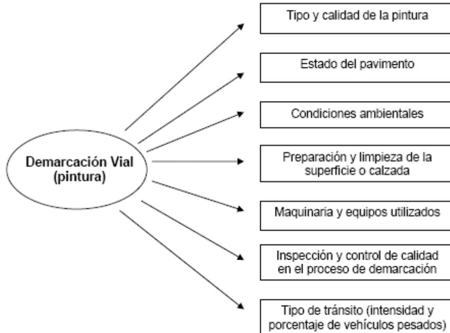
**Figura 4. Factores principales que inciden en el desempeño de la demarcación vial (LanammeUCR, 2008).**
