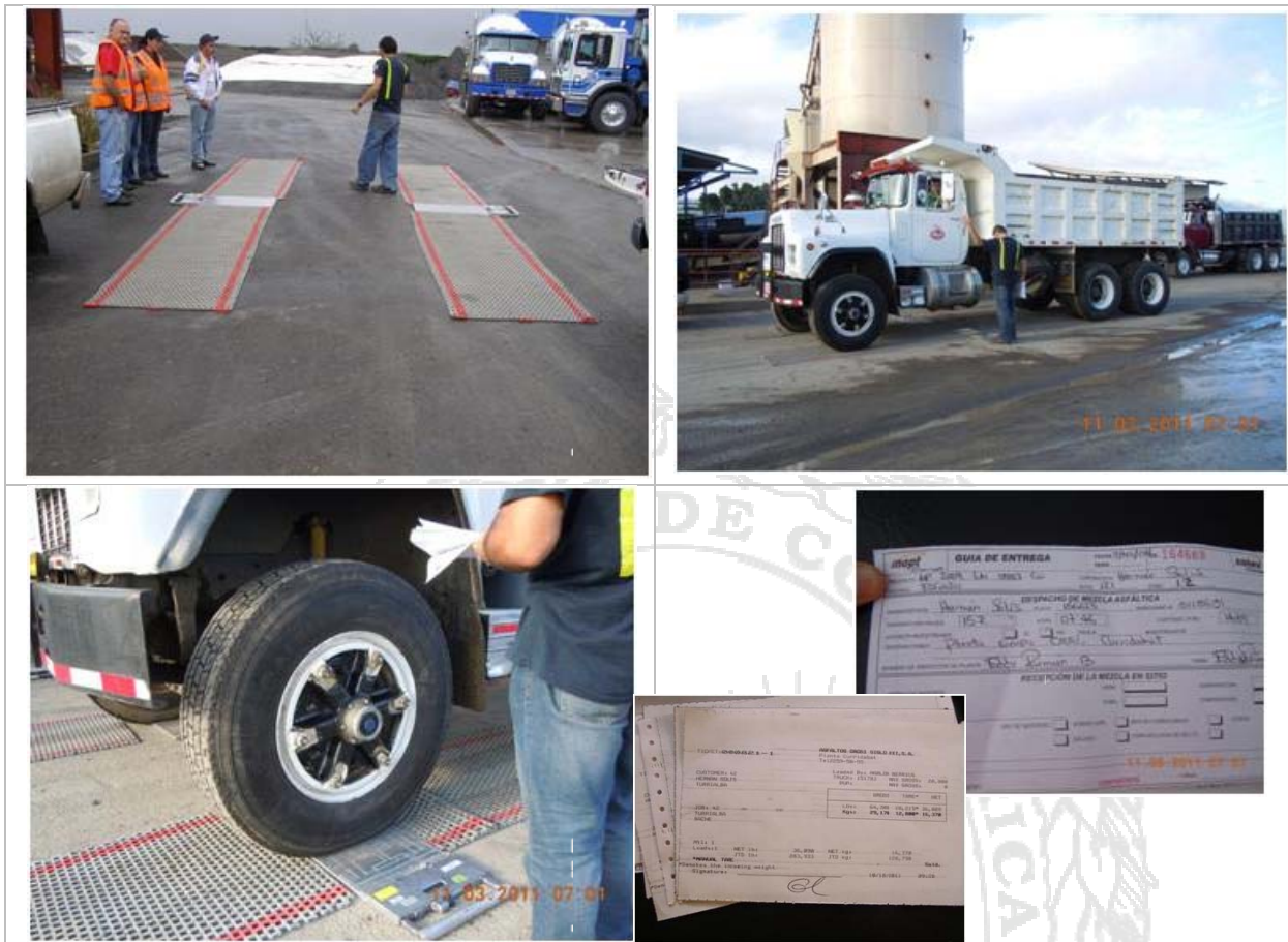
Fotografía 11 Proceso de pesaje de vagonetas en planta y boleta de despacho.
