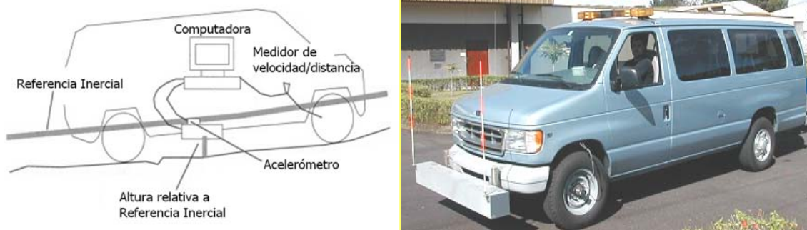
Figura 1. Perfilómetro Inercial Láser (Fuente: LanammeUCR, 2008).
