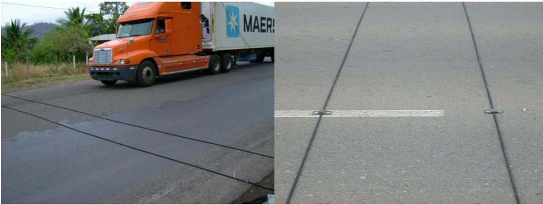
Figura 4. Cables y contadores automáticos en sitio. (Fuente: LanammeUCR, 2008).
