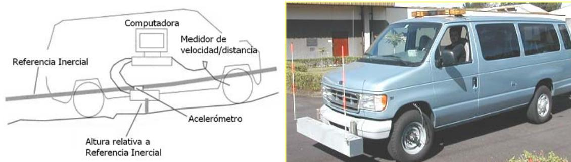
Figura 11. Perfilómetro Inercial Láser (Fuente: LanammeUCR, 2008).
