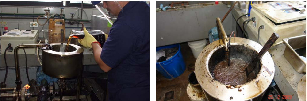
Figura 13: Producción de emulsión asfáltica en el laboratorio.
