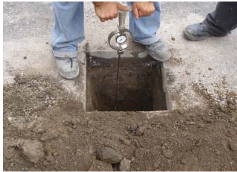
Figura 20. Prueba de CBR en sitio Fuente: LanammeUCR, 2008.
