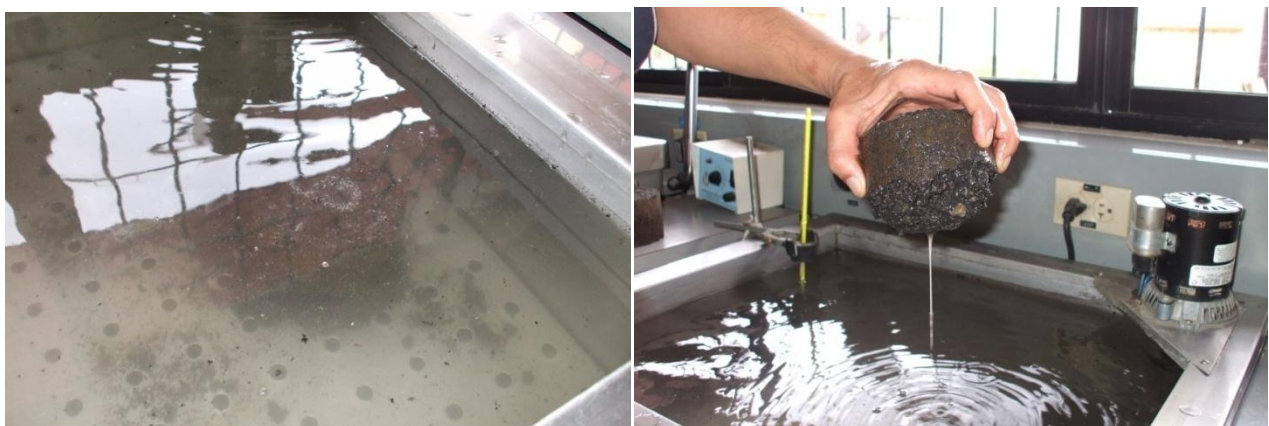
Figura 16: Desintegración de especímenes para un 6.8 % de emulsión inicial.
