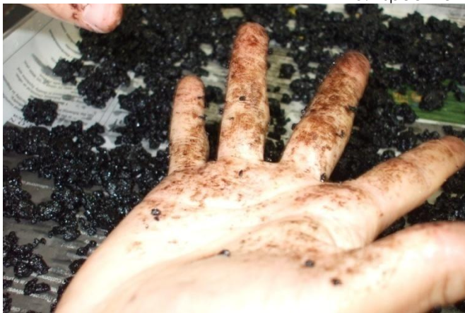
c. Presencia de solvente en la mezcla con asfalto rebajado
