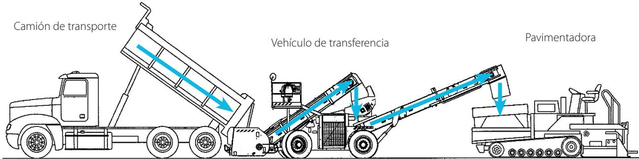
Figura 16. Vehículo para transferencia de material para la colocación de mezcla asfáltica. Adaptado por: Cervantes, 2018 a partir de Conveyor Clean-Out for Material Transport Vehicles, 2008.
