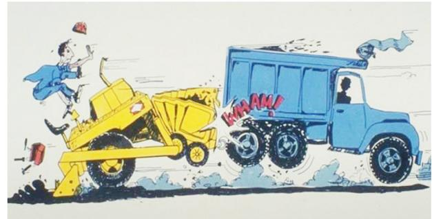
Figura 14. Prevenir que el camión transportador no golpee la pavimentadora durante la colocación de mezcla asfáltica.
