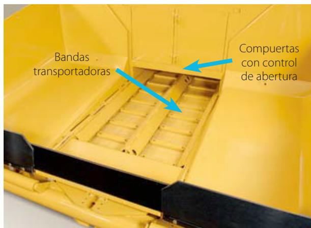
Figura 17. Compuertas de flujo y bandas transportadoras de pavimentadora.
