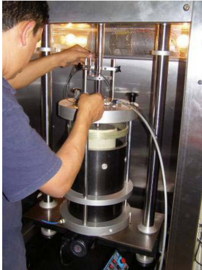
Figura 27: Colocación de deformímetros externos.
