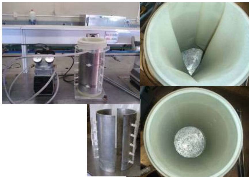
Figura 8: Molde de 152 mm de diámetro con sus accesorios y colocación de la membrana.
