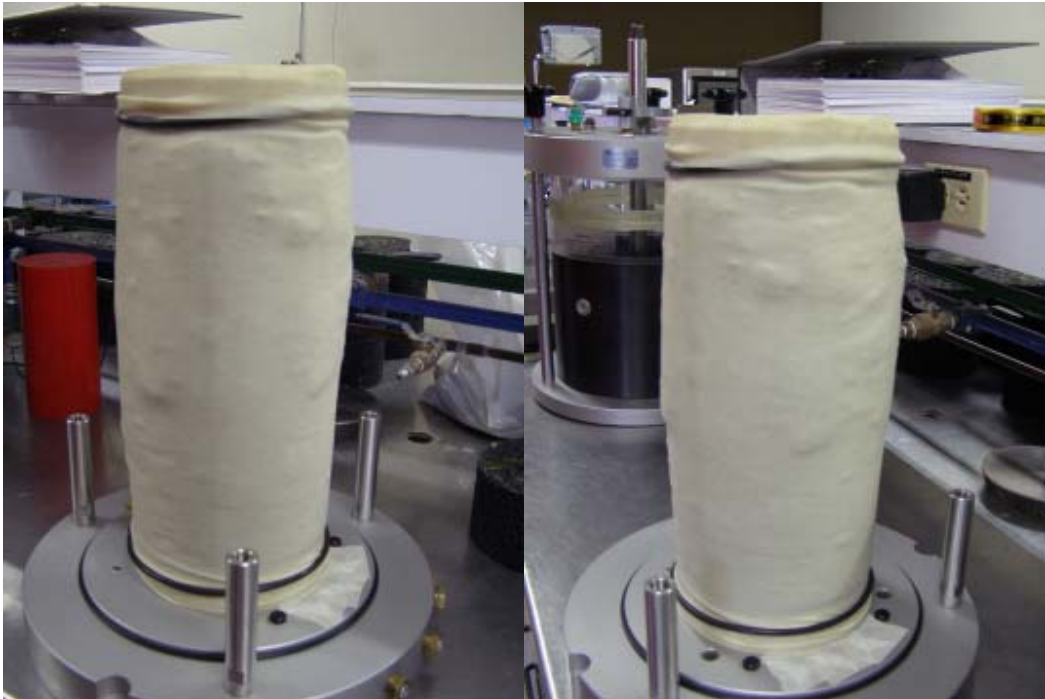
Figura 30: Falla del espécimen en el preacondicionamiento del material M3 .
