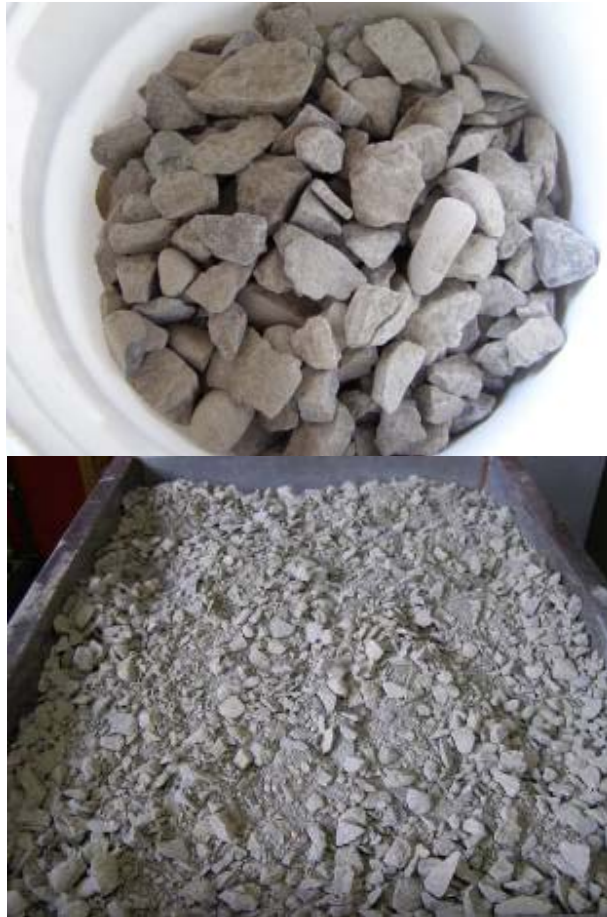
Figura 36: Agregado retenido en el tamiz de 19 mm y agregado que pasa el mismo tamiz del material M4 .
