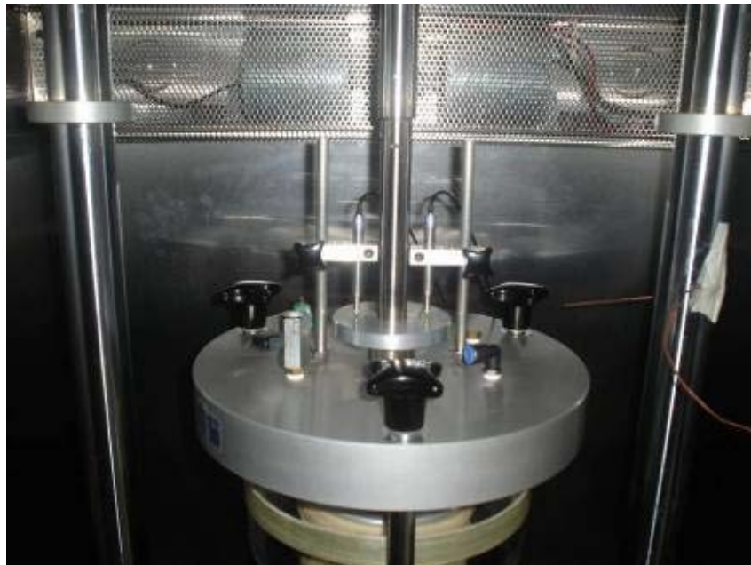
Figura 11: Arreglo de los deformímetros fuera de la cámara triaxial.
