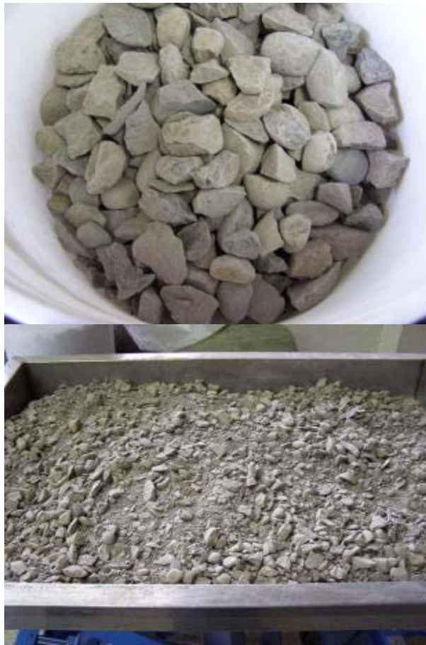
Figura 35: Agregado retenido en el tamiz de 19 mm y agregado que pasa el mismo tamiz del material M3 .
