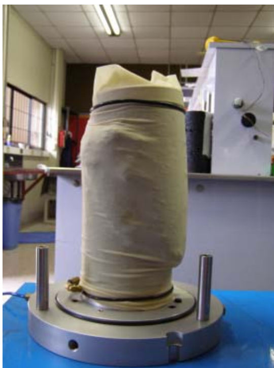
Figura 28: Falla del espécimen en el ciclo 12 del material M1 de 150 mm de diámetro.
