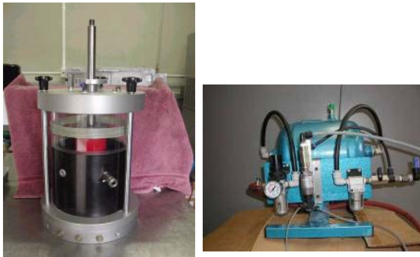
Figura 9: Cámara triaxial y tanque neumático.
