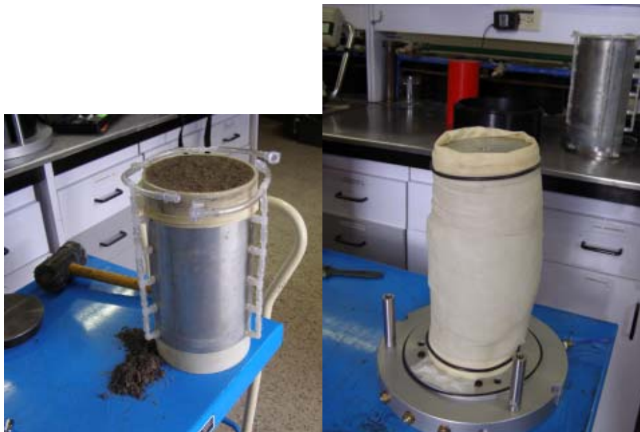
Figura 29: Falla del espécimen en el precondicionamiento del material M2 .
