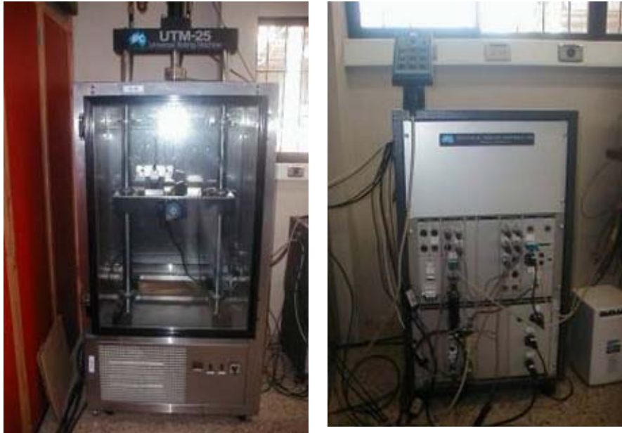
Figura 10: Marco de carga y el sistema CDAS de circuito cerrado.
