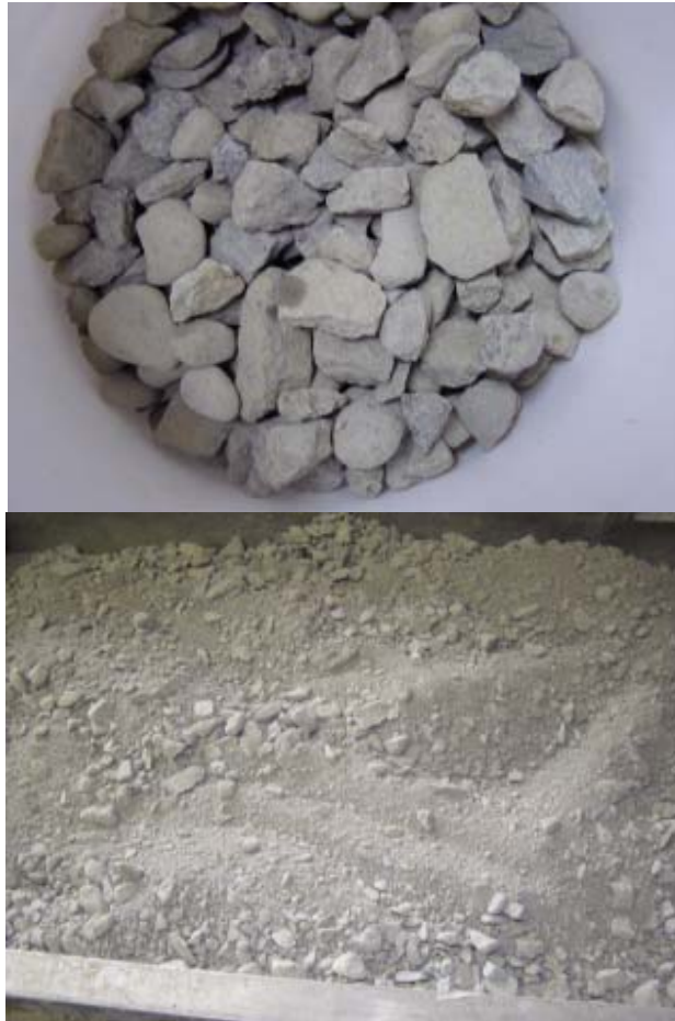
Figura 34: Agregado retenido en el tamiz de 19 mm y agregado que pasa el mismo tamiz del material M2 .
