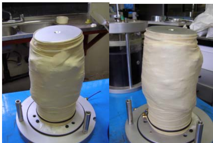
Figura 32: Falla del espécimen en el precondicionamiento del material M5 .
