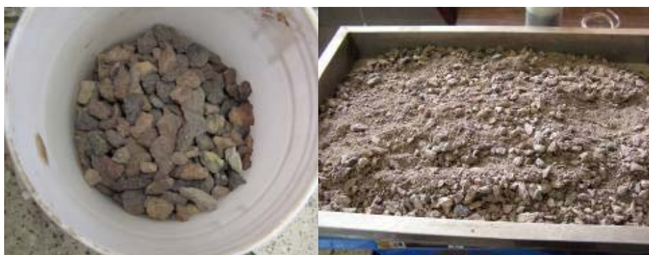
Figura 33: Agregado retenido en el tamiz de 19 mm y agregado que pasa el mismo tamiz del material M1 .
