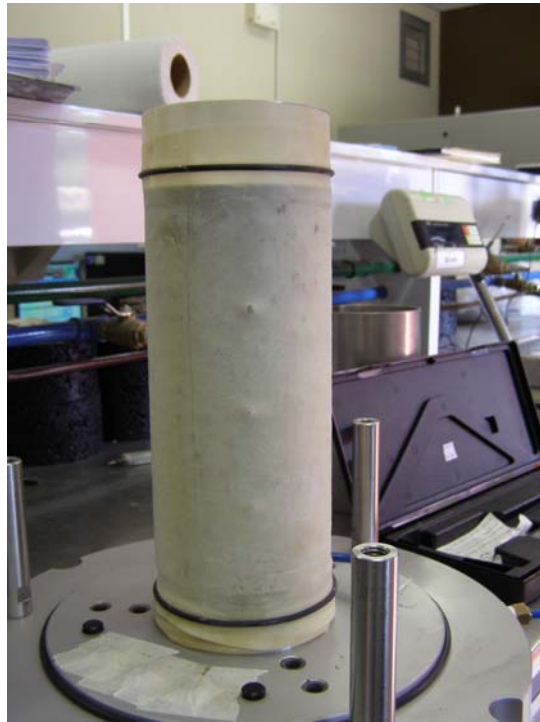
Figura 25: Espécimen compactado colocado en la base de la cámara triaxial.
