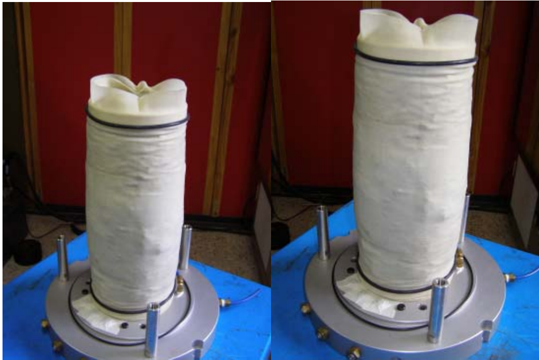
Figura 31: Falla del espécimen en el preacondicionamiento del material M4 .
