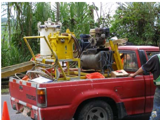
Fotografía 9. Equipo para demarcar horizontalmente figuras y letras. (29 de abril del 2008)
