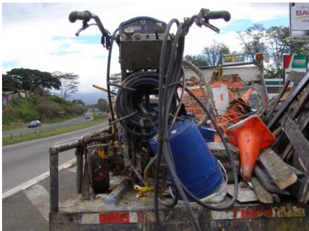
Fotografía 7. Equipo para demarcación manual que trabaja a presión sin aire. (18 de abril del 2008)
