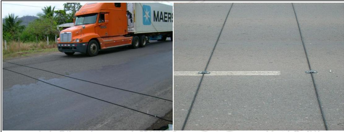
**Figura 4.** Mangueras y contadores automáticos en sitio.
