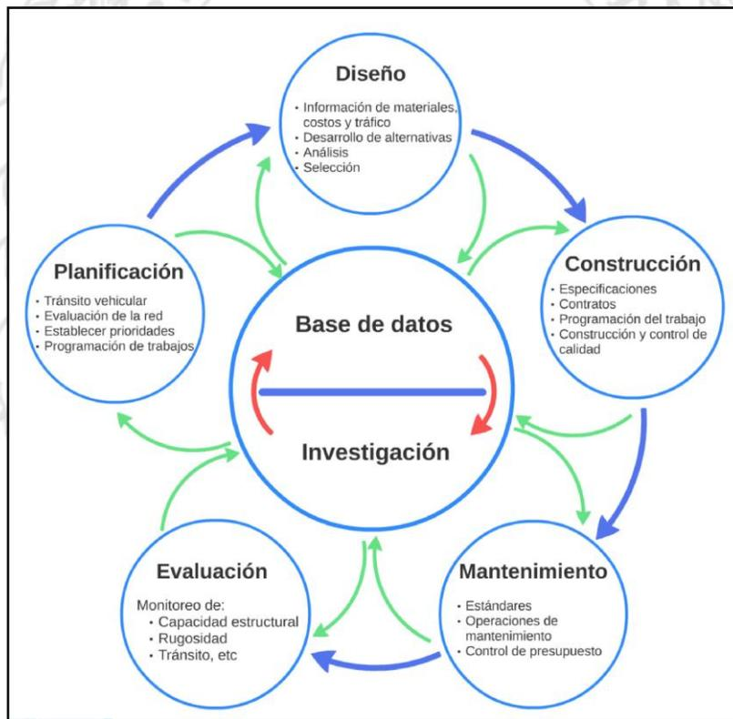
**Figura 1.** Estructura general de un sistema de gestión de pavimentos.
