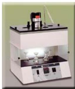
**Figura 3:** Equipo de ensayo para viscosidad Saybolt Furol.
