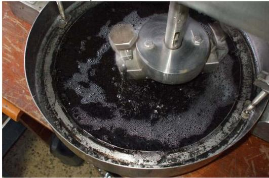
c.Ensayo de abrasión
