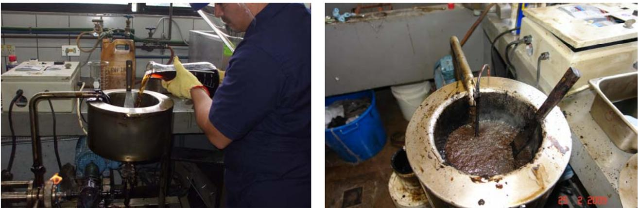
**Figura 13:** Producción de emulsión asfáltica en el laboratorio.
