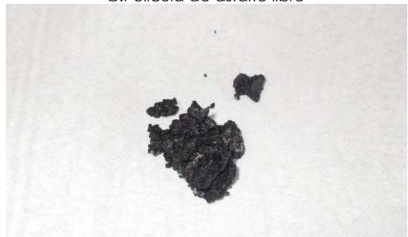
d.Muestra seca después de la ebullición
