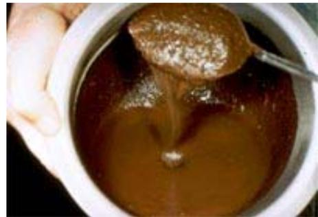
b. Consistencia de la lechada asfáltica
