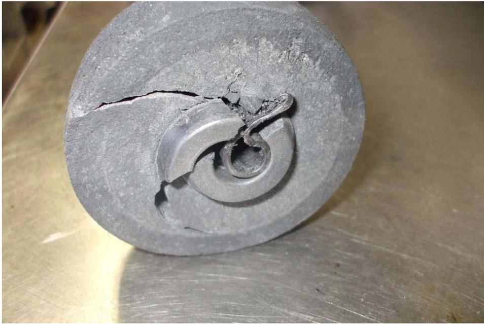
**Figura 26:** Rueda dañada por el peso de 57 kg.
