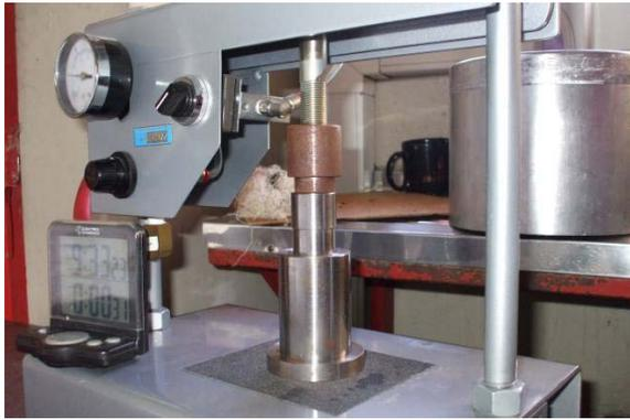
a. Equipo para el moldeo de especímenes
