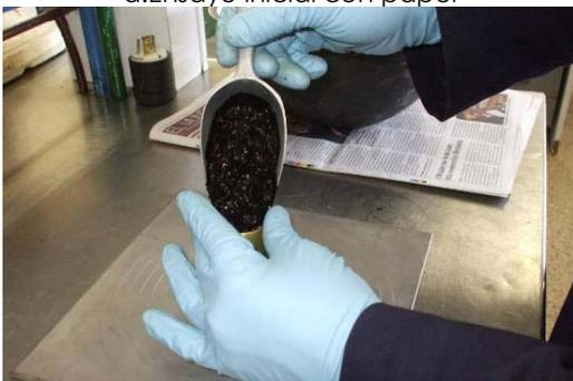
c. Colocación de muestra dentro del cono
