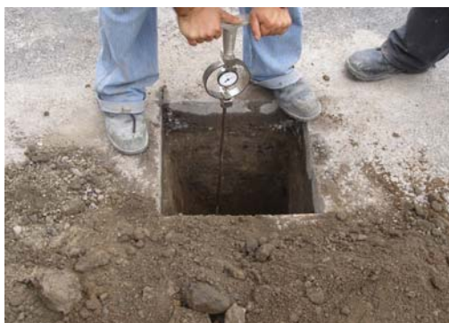
Figura 21. Prueba de CBR en sitio (Fuente: LanammeUCR, 2008).
